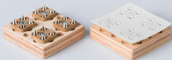
Pro vyrobení zakázky je nutné demontovat matrici a raznici lisu, seřadit střížné vložky na požadovaný tvar produktu. Každou zakázku je nutné připravit a vystříhnout z formy.
